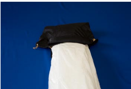
3.1. Die Fixierung des Fanggurtes ist nun zu lösen. Oberer Teil der Kappe in den Innencontainer legen.
