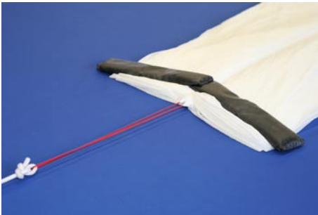
2.3. Nun wird der an den Packschlaufen eingezogene Scheitel gerichtet und mit einem Packgewicht beschwert.
