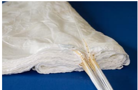
2.6. Nun mit dem kompletten Fangleinenbündel zus. mit den linken Bahnen zurück zur Mitte der erstgelegten Bahn.
